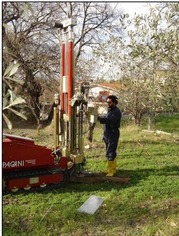
*Foto 1: Prova penetrometrica dinamica continua tipo DPSH - Località Cerraiolo (Cer 1)*
