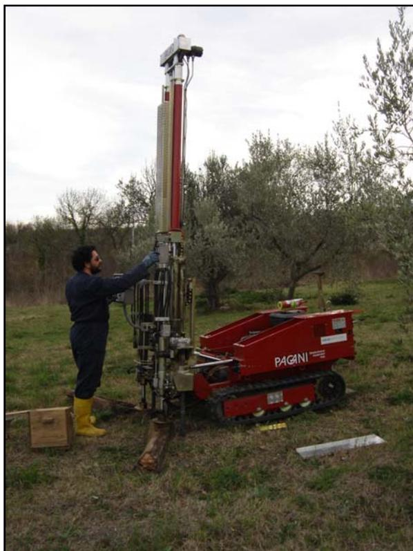
*Foto 2: Prova penetrometrica statica continua tipo CPT - Località Cerraiolo (Cer 2)*
